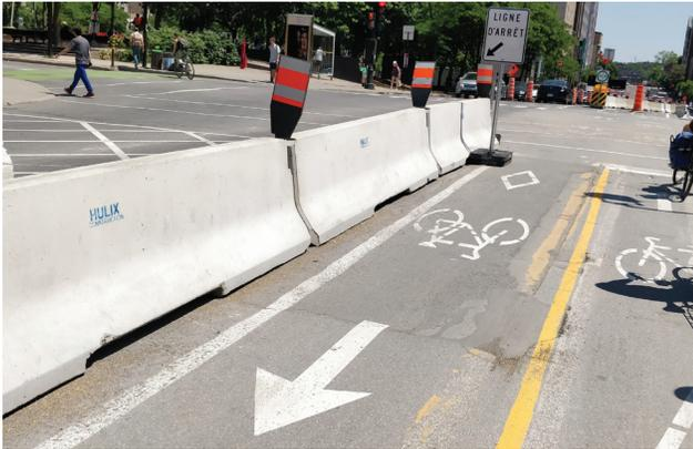
Les glissières de sécurité de type Jersey sont un dispositif de retenue fréquemment utilisé sur les chantiers. L'approvisionnement est facile puisque plusieurs fournisseurs en produisent. De plus, ces glissières sont homologuées par le MTMD et peuvent être installées sur presque tous les types de routes en suivant les normes du Tome VIII. Sa hauteur peut être une nuisance si elle est utilisée en milieu urbain ou à des endroits où des piétons doivent traverser.
