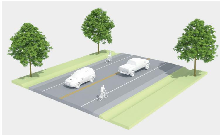
Figure 9 – Accotement asphalté
